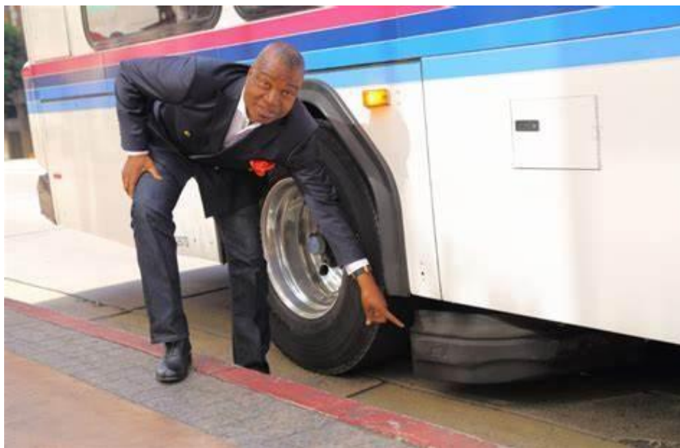
IMAGEN 10. Barrera de protección anti-atropellamientos para ruedas traseras S-1 Gard. Foto: http://s1gard.eu
