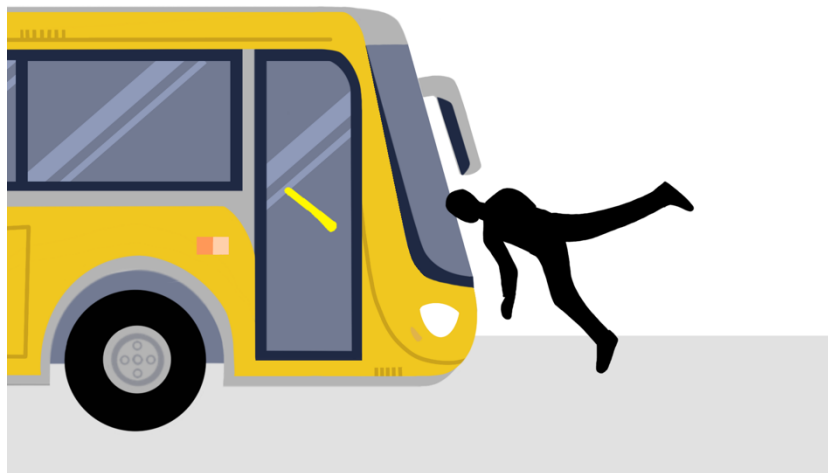
IMAGEN 8. Comparativa de la dinámica de un cuerpo impactado entre un frente muy vertical contra otro más inclinado. Ilustración: elaboración propia con base en imagen de European Transport Safety Council. https://etsc.eu
