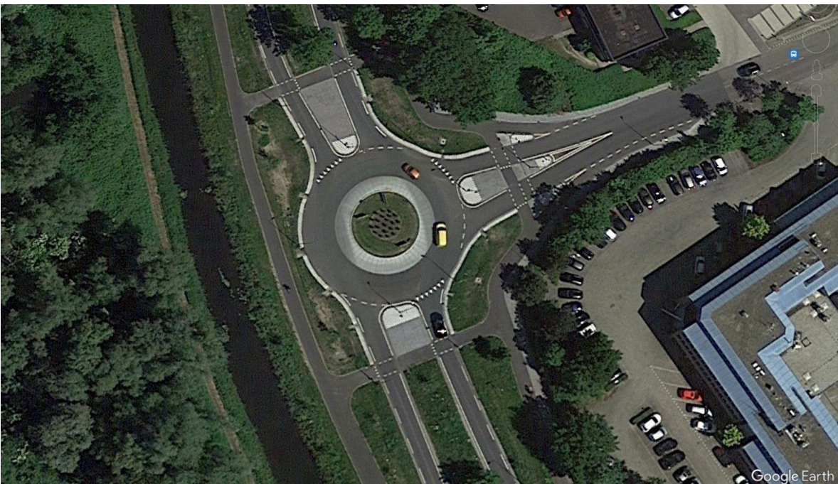
IMAGEN 2. Glorieta implementada a partir del atropellamiento a dos ciclistas en Engelen, Países Bajos. Destaca la reducción de carriles y el ajuste de ancho de los carriles. La configuración de glorieta permite reducir puntos de conflicto y velocidad, en comparación con la configuración anterior de intersección. Fuente: Google Earth.
