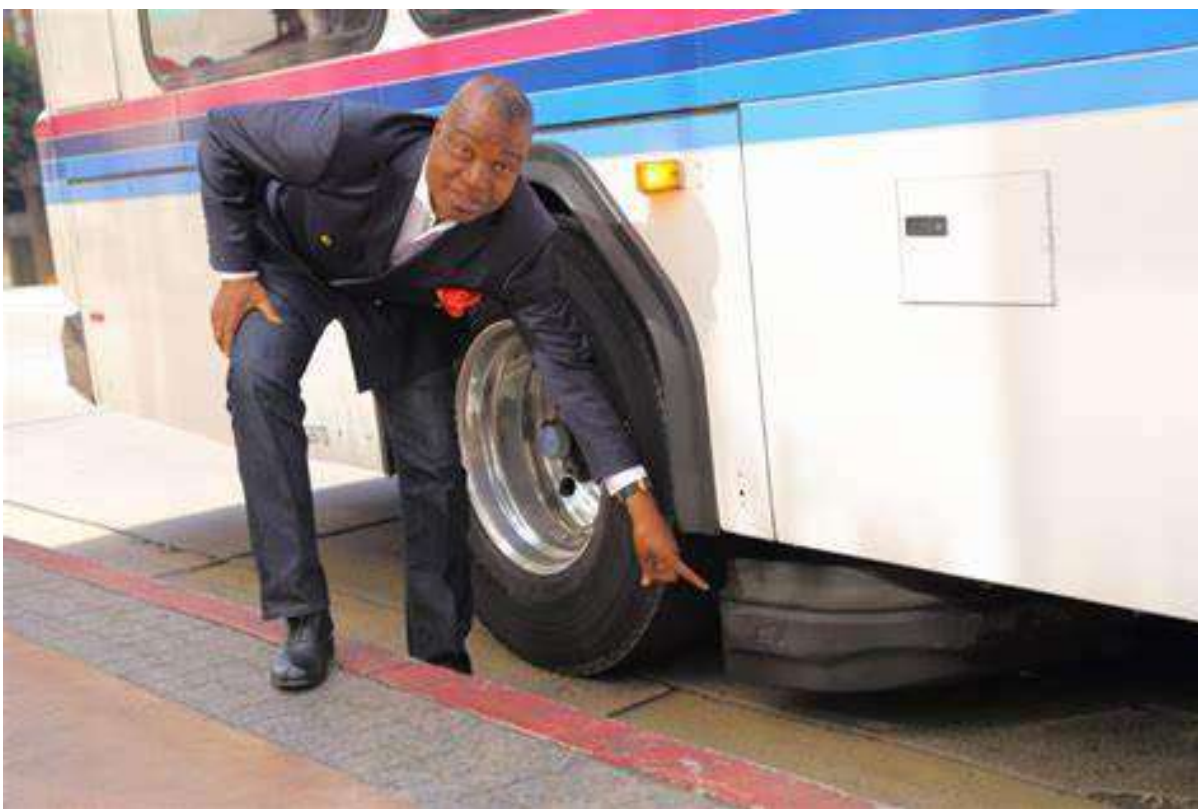
IMAGEN 10. Barrera de protección anti-atropellamientos para ruedas traseras S-1 Gard. Crédito: http://s1gard.eu
