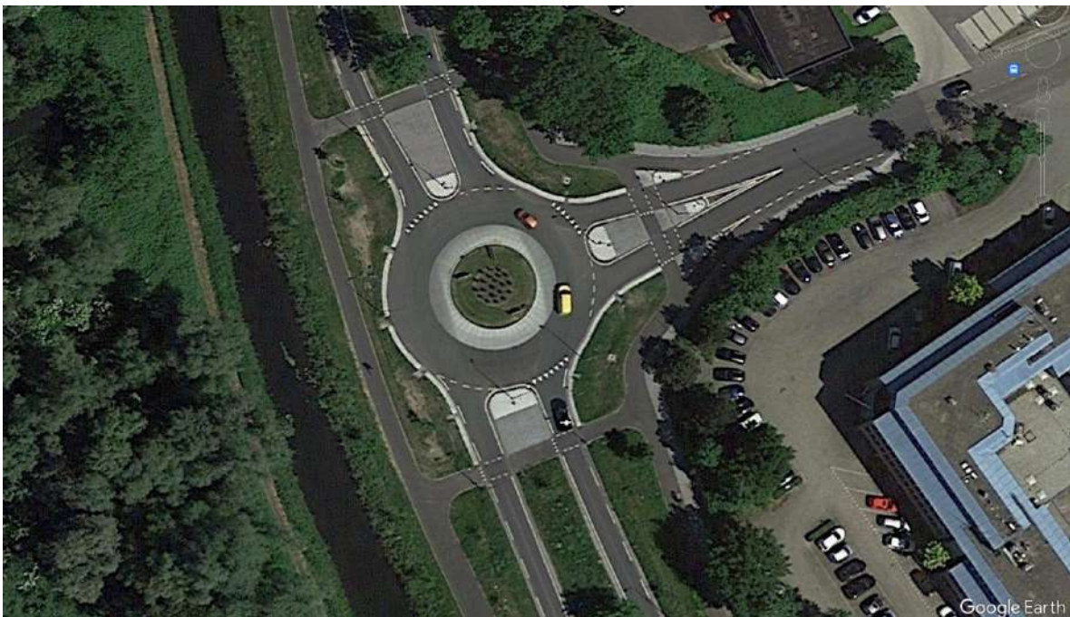
IMAGEN 2. Glorieta implementada a partir del atropellamiento a dos ciclistas en Engelen, Países Bajos. Destaca la reducción de carriles y el angostamiento de ancho de los carriles. La configuración de glorieta permite reducir puntos de conflicto y velocidad, en comparación con la configuración anterior de intersección. Crédito: Google Earth.
