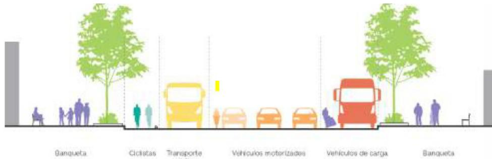
**Ilustración 11.** Sección vial con carril para vehículos de carga y descarga. Fuente: *Manual de calles* de SEDATU, 2019
