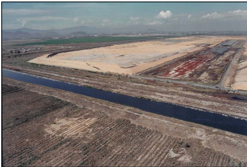
Figura 7. SDF de Residuos alojado en parte, en la zona de inundación de una corriente superficial.
