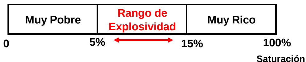
Figura 35. Rango de explosividad del gas metano.
